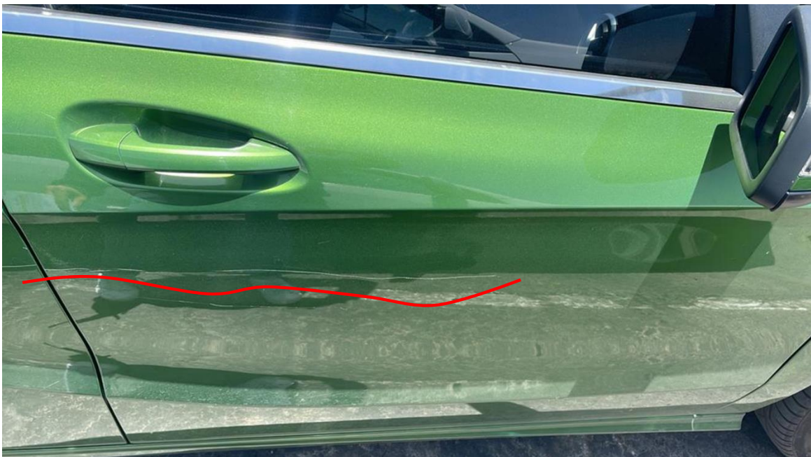
IMAGEN 1: Daño por abolladura leve y raspón profundo, puerta trasera lado derecho. (en línea roja se registra trazo del daño)
