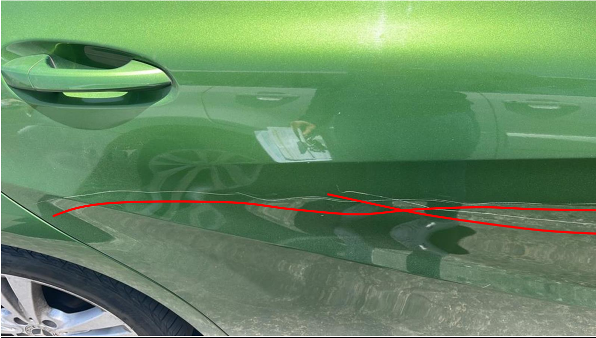
IMAGEN 1: Daño por abolladura leve y raspón profundo, puerta trasera lado derecho. (en línea roja se registra trazo del daño)
