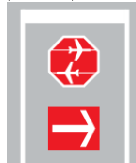
Señal de STOP paso de aviones, señal de preaviso y banda de parada
